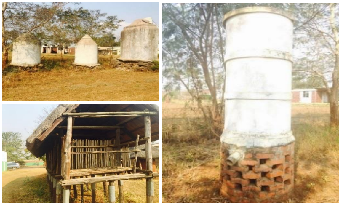
Figura 4: Protótipo de cabanas de armazenagem de baixa tecnologia para grãos na Zâmbia
