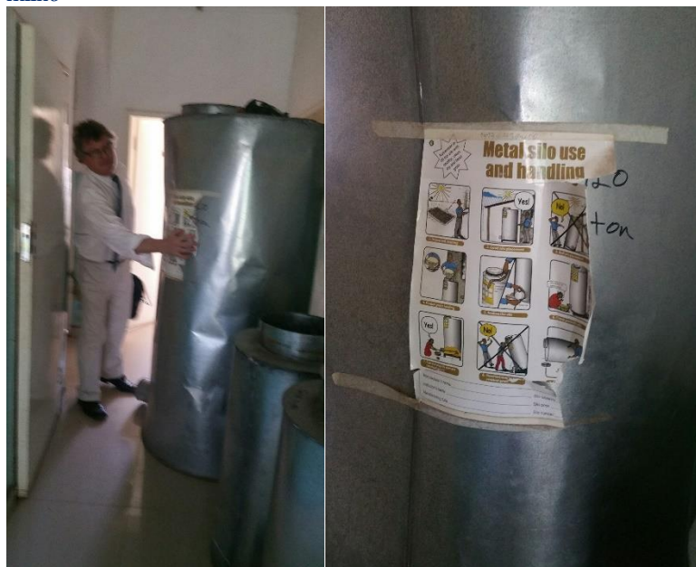
Figura 9: Unidades modernas de armazenagem de pequena escala eficazes na prevenção do aumento da aflatoxina no milho
